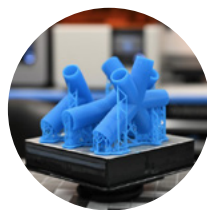
Dispositivos de separación de tubos (para múltiples pacientes) para respiradores
