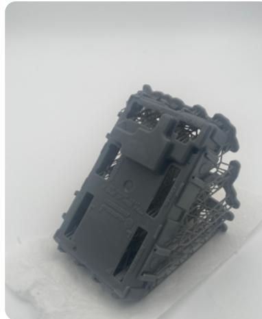
Form 3+ (N3) による造形品。写真はそれぞれ異なる段階で撮影したもの。写真左から、プリント直後でまだプリンタに入ったままの状態、サポート材が付いた状態で一回目の洗浄を行った後、サポート材を取り外して二次硬化を終えた最終状態。
